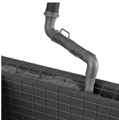
Figura 28 Colocación de codo
