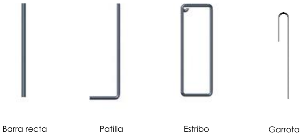
Figura 25 Refuerzos para paneles Sismo
