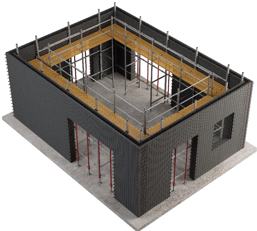
Figura 24 Comprobar la correcta instalación antes del vertido de hormigón
